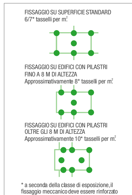
7. Esempi di fissaggio meccanico su latero-cemento
